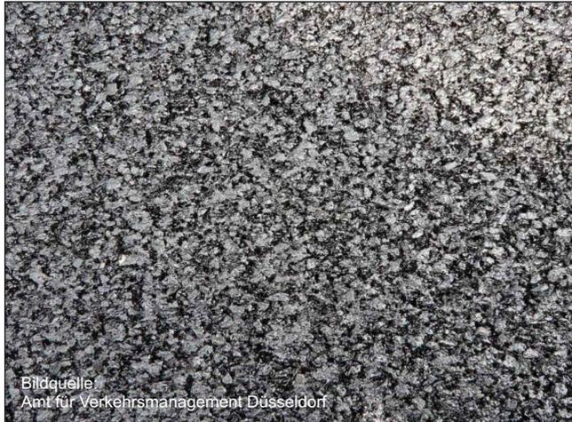
Beispiel Oberfläche lärmoptimierter Asphalt
