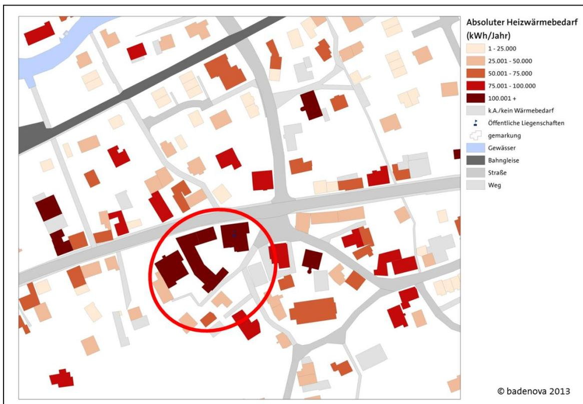
Abbildung 21 - Absoluter Heizwärmebedarf auf Gebäudeebene
